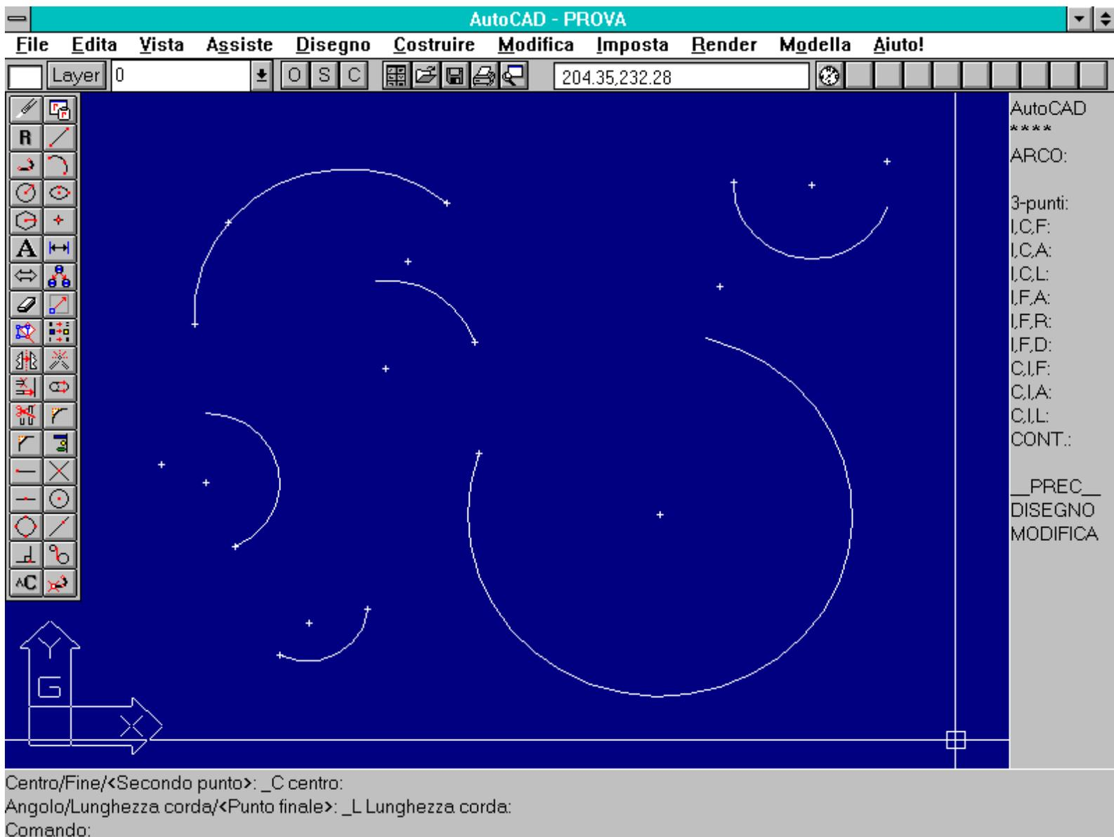
*Esempi di archi ottenuti con alcune delle opzioni disponibili del comando ARCO [ARC]. Esistono almeno dieci modalità diverse per definire un arco: sarà scelta, di volta in volta, quella più confacente alle proprie necessità del momento.*
