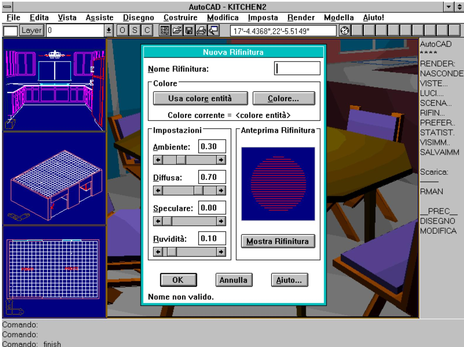
*Comando RIFIN [FINISH]. Riquadro di dialogo attivato dall'opzione Nuova rifinitura del riquadro principale. E' possibile ottenere un'anteprima, in funzione della capacità del materiale di riflettere la luce diffusa e ambiente e della sua specularità e ruvidezza.*
