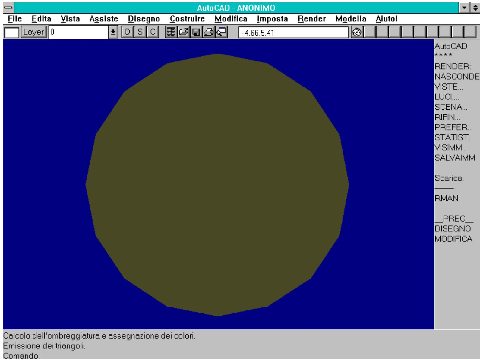
*Esempio di rendering di una sfera azzerando la luce distante di default e ponendo a 1 il valore per la luce ambiente. Come è evidente, la sola luce ambiente non è in grado di descrivere la superficie curva di una sfera.*
